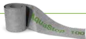
**Nastro impermeabile elastico in polietilene rivestito su ambo i lati da polipropilene non tessuto ad elevata adesione per giunti perimetrali e di frazionamento-dilatazione nel sistema Laminato No Limits® 2 e per la sigillatura di giunti perimetrali e tra teli adiacenti nel sistema Laminato No Crack 3.**
